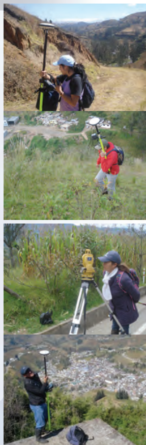
Figura 14.- Levantamiento topográfico con GPS diferencial y estación total.
